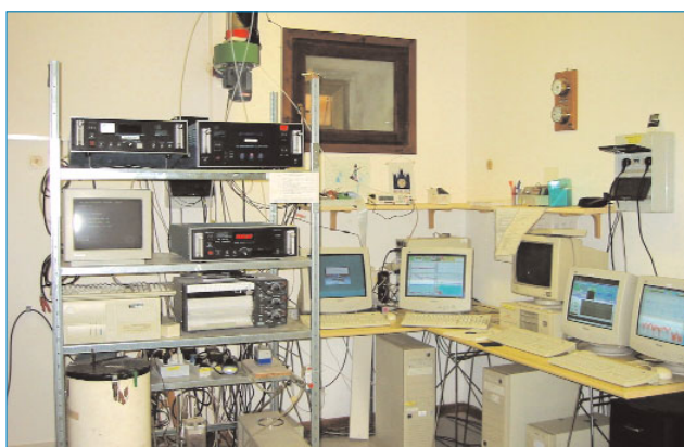
Uno dei quattro laboratori che formano la Stazione CNR. In alto è visibile la turbina di aspirazione che distribuisce l'aria a diversi analizzatori. I software di acquisizione e sono stati realizzati in ambito CNR.
